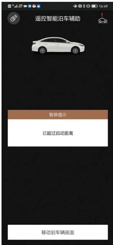
您在操作过程中界面出现暂停提示“已超过启动距离”说明已经超过最大泊车距离。您点击【移动到车辆画面】界面返回到车辆遥控主页面，重新进行操作。
