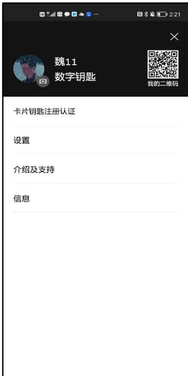
第一步：在数字钥匙应用程序的右上角点击【菜单】>【卡片钥匙注册认证】按钮，完成之后，将卡片钥匙放在车辆的无线充电板上
