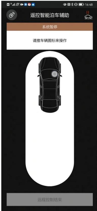
您在使用智能泊车功能时如出现提示：系统暂停，请按照箭头指示，滑动车辆图标再次尝试进行操作
