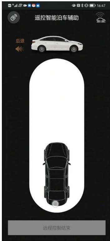
您在操作过程中按照界面提示“沿箭头方向滑动车辆图标，车辆就会往该方向垂直移动”。
