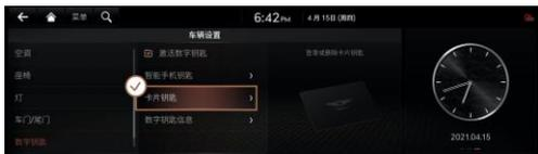
打开车载导航屏幕-点击【设置】>【车辆】>【数字钥匙】>【卡片钥匙】>【注册】
