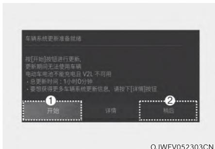
车辆电源[OFF]后，可以更新系统软件。
