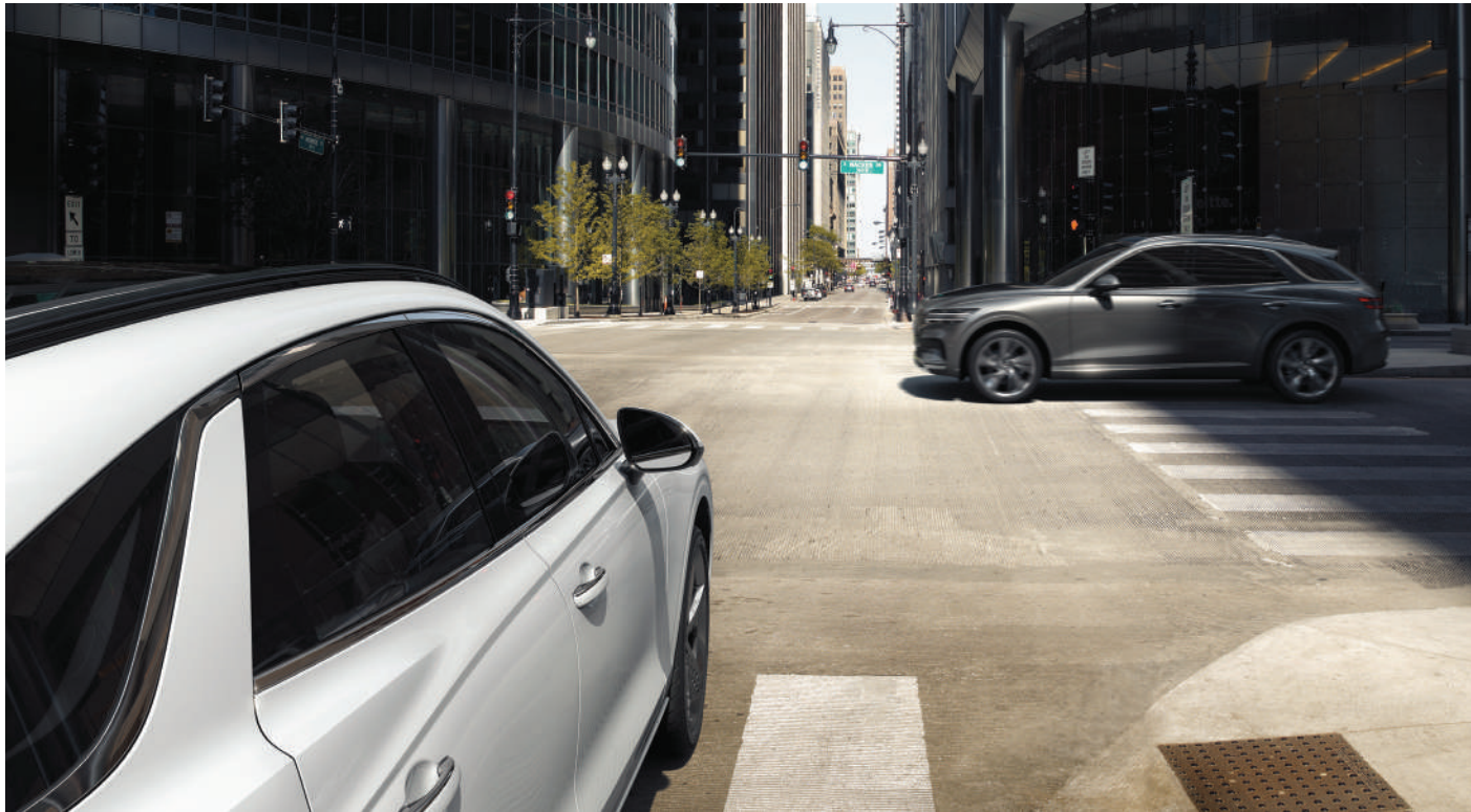
前方防止碰撞辅助 (交叉路口交叉车辆, 超车时对向车辆, 侧方接近车辆, 回避转向辅助) 前方车辆突然减速或与前方车辆, 行人, 自行车发生碰撞危险时, 该系统会预先警告并辅助刹车。和十字路口左右两侧靠近车辆发生碰撞危险时, 也会辅助刹车。此外, 在行驶过程中变更车道时, 如果发现与对面驶来的车辆及旁边车道车辆有碰撞险, 可以辅助车辆进行转向。行驶过程中, 前方有行人进入车道内侧发生碰撞危险时, 也可以辅助车辆转向。
